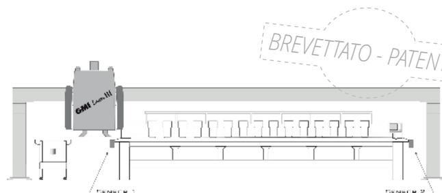
**Sistema di auto calibrazione del raggio laser** Laser auto-calibration device
